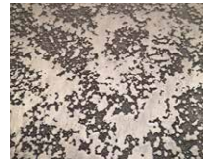
Bronzo corrosivo Corroded bronze
